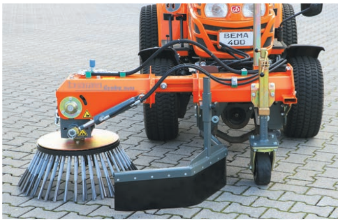
Flexibel dank der teleskopierbaren seitlichen Verschiebung (300 mm)
